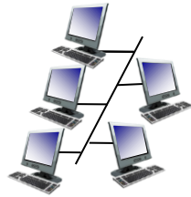
διαμοιραζόμενο καλώδιο (π.χ., Ethernet καλωδίου)
