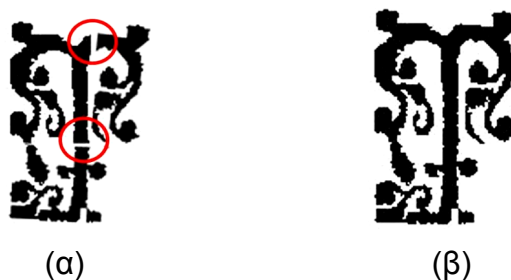
Σχήμα 4.8: Παράδειγμα προσθήκης συνδεδεμένου συστατικού στο τελικό αποτέλεσμα με χρήση της μεθόδου (α) SBD και (β) TSD.v1. Οι κύκλοι δείχνουν τα σπασίματα που προκύπτουν από τη μέθοδο SBD.
