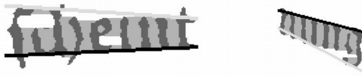
Σχήμα 4.10: Προσδιορισμός της γραμμής αναφοράς σε λέξεις με τη μέθοδο TSD.v2. Η γραμμή αναφοράς που επιλέγεται απεικονίζεται με μαύρο χρώμα.
