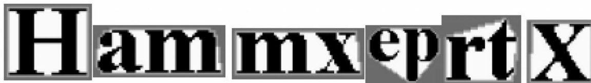
Σχήμα 2.38: Χαρακτήρες περικλειόμενοι από το κυρτό κέλυφος. Τα pixels που απεικονίζονται με μαύρο, ανοιχτό γκρι και σκούρο γκρι χρώμα αντιπροσωπεύουν τους χαρακτήρες, το κυρτό σχήμα και την περιοχή ανάμεσα στο κυρτό σχήμα και του πλαισίου του χαρακτήρα, αντίστοιχα.
